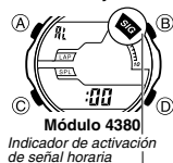
Módulo 4380 Indicador de activación de señal horaria
